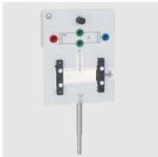
Dans support, avec bande d'argent fixe, paires de douilles pour branchement électrique et mesure de la tension de Hall ainsi qu'avec un potentiomètre pour le réglage du zéro. Sur tige pour le montage sur le noyau en U (de 562 11 ).
