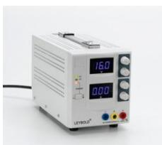
Alimentation CC, comme source de tension constante avec limitation de courant et comme source de courant constant avec limitation de tension, permet un fonctionnement en parallèle et en série de plusieurs appareils.
