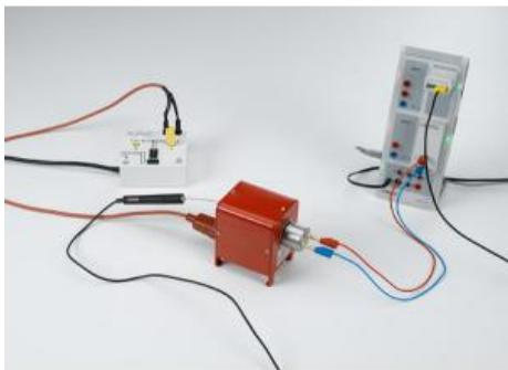
Dans les expériences P7.2.2.1 et P7.2.2.2, on mesure la valeur de la résistance en fonction de la température dans un montage en pont de Wheatstone.
