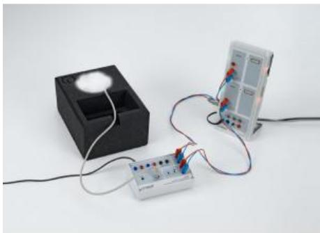
Dans l'expérience P7.2.6.1, on détermine la température critique du supraconducteur à haute température  $\text{YBa}_2\text{Cu}_3\text{O}_7\text{-x}$ .
