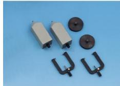
Pour réaliser un électro-aimant à l'aide des éléments du transformateur démontable afin d'obtenir des champs magnétiques homogènes ou non homogènes dans un espace réduit.
