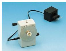
avec porte-disque et pince pour la fixation sur un support.
